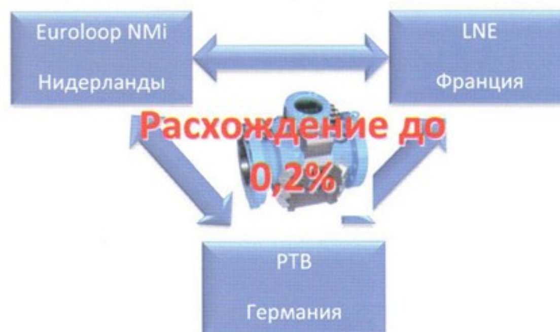
Рис. 7. Сравнение единицы измерения, которая может быть передана общепризнанными мировыми эталонами расхода газа
