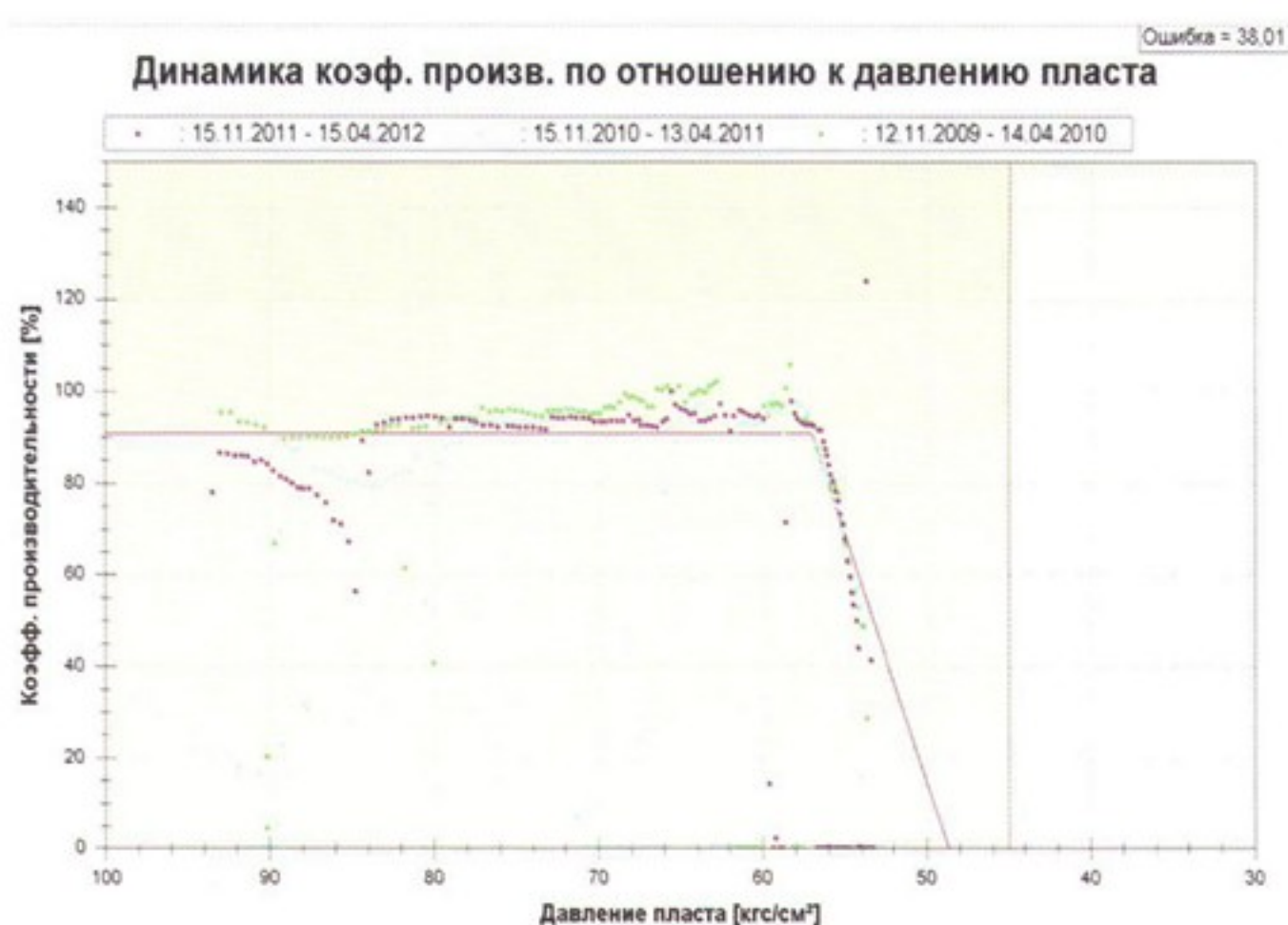
Рис. 4. График анализа производительности скважины
